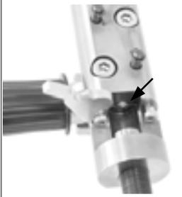
Cabeza de reborde fabricada según DIN-F
